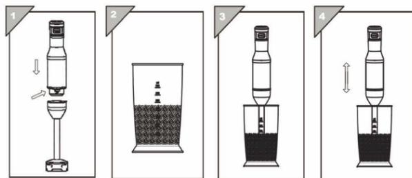
1. Вставьте шток блендера в блок двигателя и зафиксируйте его со щелчком. Для демонтажа достаточно нажмите кнопку, чтобы отсоединить шток блендера от блока двигателя.
