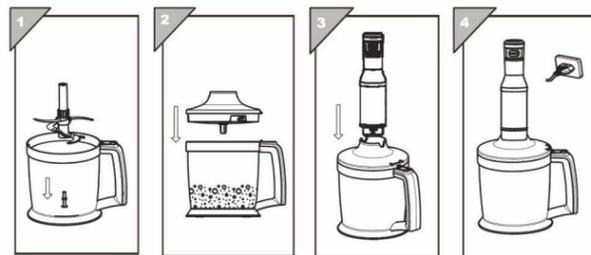
1. Установите ножевой блок измельчителя на центральный шпindel чаши.
