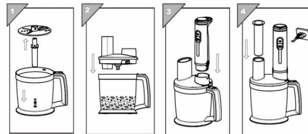
1. Установите диск нарезки/шинковки на втулку вала, затем установите собранный диск на центральный вал чаши.
