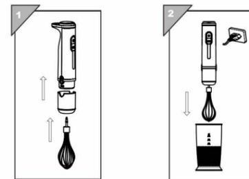
1. Сильно вставьте венчик в соединительный узел венчика, затем вставьте блок двигателя в соединительный узел венчика. блок двигателя на муфту венчика.
