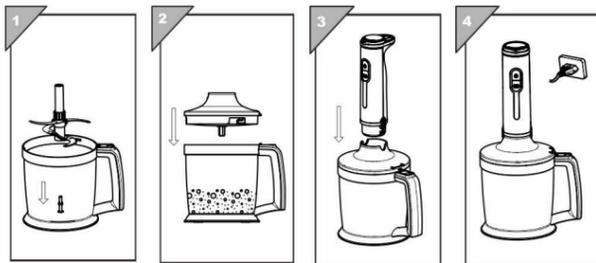
1. Установите ножевой блок измельчителя на центральный шпindel чаши.
