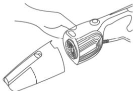
1. Нажмите кнопку фиксации пылесборника, чтобы снять пылесборник.
