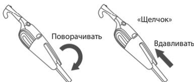
2. Установите и поверните щелевую насадку, после чего нажмите на нее в направлении к корпусу пылесоса до характерного щелчка.
