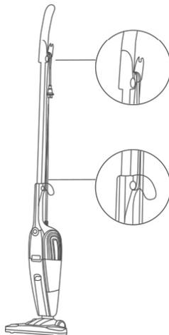
4. После использования устройства выньте вилку из розетки, обмотайте шнур питания вокруг держателей сетевого шнура для более удобного хранения.
