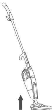
2. Установите фильтр и контейнер — пылесборник. Вставьте насадку для пола и ковров в устройство до характерного щелчка.
