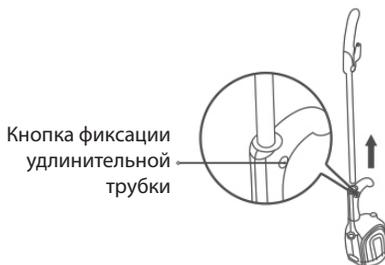
1. Нажмите кнопку фиксации удлинительной трубки и потяните трубку вверх.
