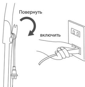
1. Поверните верхний держатель для фиксации сетевого шнура, чтобы извлечь шнур. Далее вставьте вилку шнура в розетку.
