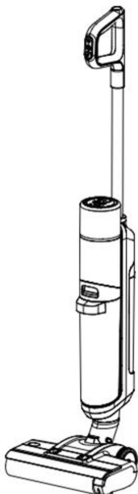
Основной блок с установленными резервуарами для воды;
